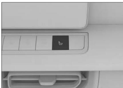
2. En la interfaz de configuración del aire acondicionado, toque el botón del asiento izquierdo o derecho para ajustar el nivel de calefacción o ventilación del asiento correspondiente.
