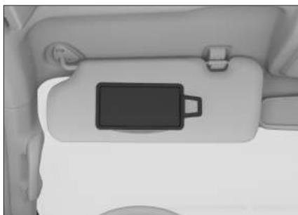
Hay un espejo de cortesía dentro de la visera, que se puede utilizar girando la tapa del espejo.
