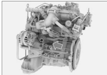
El número del motor está estampado en el bloque de cilindros del motor como se muestra en la imagen de arriba.
