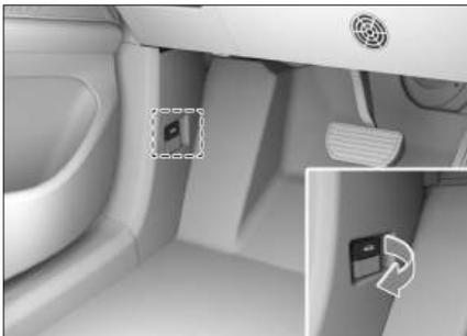
2. Coloque su mano en el espacio, gire el pestillo en la dirección de la flecha y levante el capó. El capó se elevará automáticamente al estado abierto.
