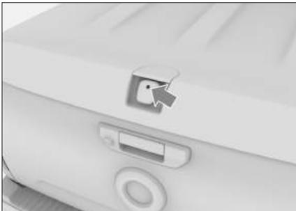
Cuando la puerta del conductor esté desbloqueada, presione el microinterruptor del toldo y luego levante manualmente el toldo.
