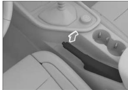
Cuando se aplica el freno de estacionamiento, la luz indicadora del freno de estacionamiento<sup>®</sup> (roja) en el tablero de instrumentos se enciende.
