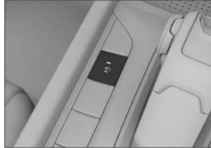
1. Después de activar el control de cruce todoterreno, presione el botón de asistencia de dirección
