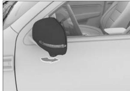
Tire del lado exterior del espejo retrovisor exterior en la dirección de la flecha para plegarlo.
