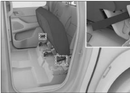
Tire de las cuerdas de los cojines del asiento en ambos lados para abatir los cojines del asiento en ambos lados respectivamente. Durante el proceso de restablecimiento del cojín del asiento, asegúrese de que la hebilla del cinturón de seguridad encaje correctamente en la ranura del cojín.
