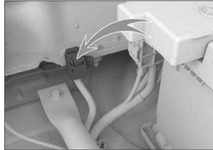
El interruptor de seguridad de la batería está ubicado debajo del maletero y se puede ver quitando la cubierta y la almohadilla del maletero y se utiliza para desconectar o conectar la fuente de alimentación del sistema de alto voltaje.
