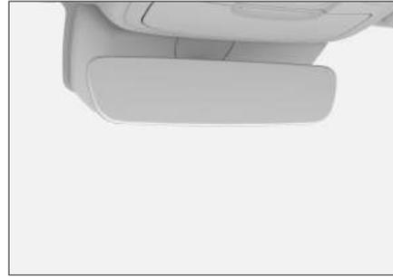
El retrovisor interior reducirá el rayo reflejado automáticamente según la intensidad de luz de los faros del vehículo de detrás.
