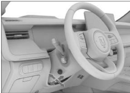
Gire la perilla de ajuste en la dirección de la flecha, ajuste el volante para alinearlos con su pecho y asegúrese de que puede ver todos los instrumentos y las luces indicadoras en el panel de instrumentos.
