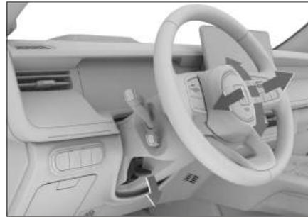
1. Libere la palanca de ajuste debajo del volante.
