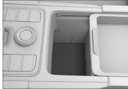
4. Utilice un destornillador plano envuelto en un paño para apalancar la placa cubierta desde la muesca, así se puede ver la palanca de desbloqueo de la marcha P.
