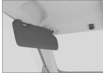
Para oscurecer el sol por parte lateral, puede bajar la visera, retire del gancho y gire a la parte lateral.
